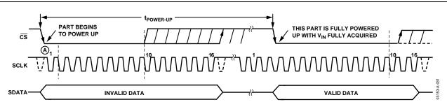
Figure 31. Exiting Power-Down Mode
